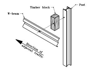
$\frac{\text{W-BEAM SPLICE CONNECTION}}{\text{DETAIL AT POST}}$
